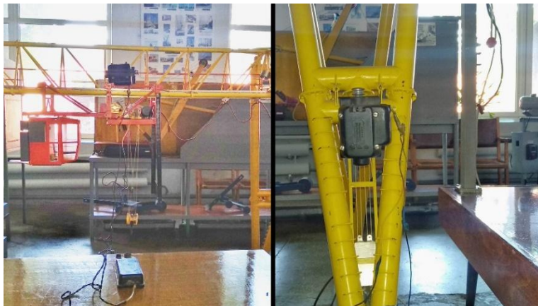
Рис. 1. Схема установки вібраційної машини: а) вібратор закріплений на мосту крана, б) вібратор закріплений на опорі крана
